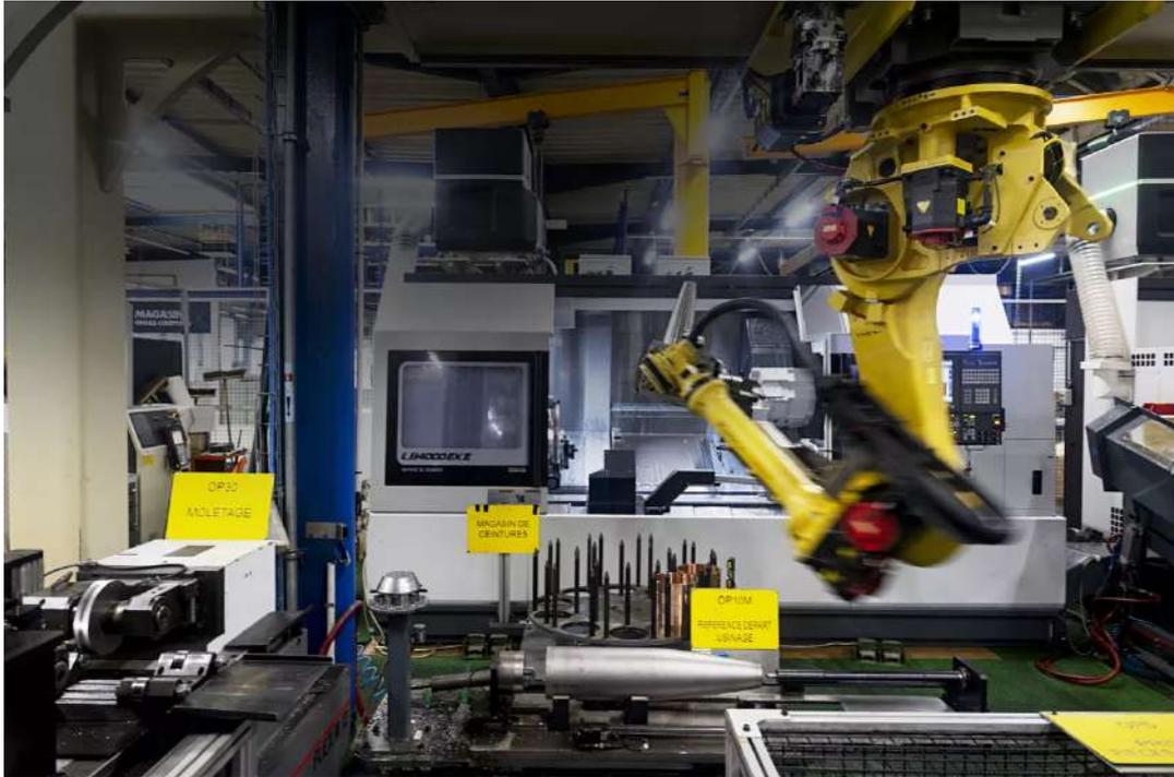
À travers sa filiale Arrowtech, Nexter fabrique aussi des munitions. Ici, l'unité de ceinturage gros calibre (155 mm).
