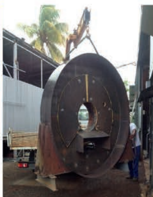
Porte de chaudière
